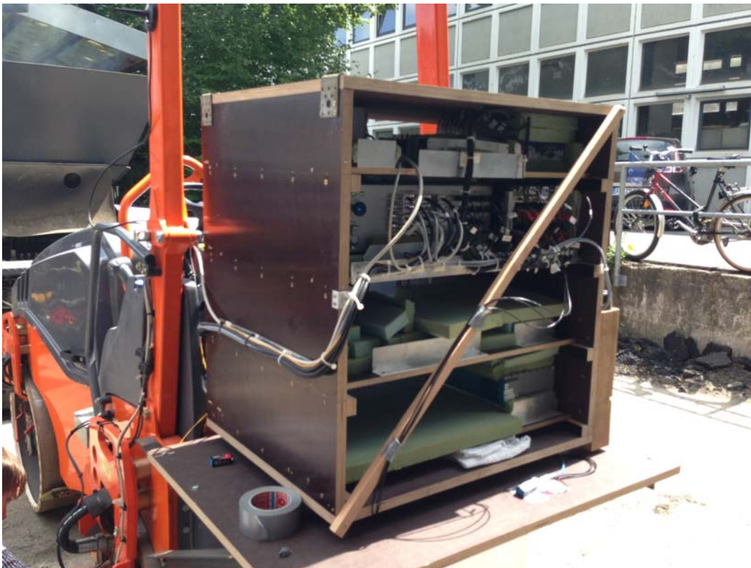
Decoder (Receiver) der Telemetrie und Messgeräte zur Aufnahme und Speicherung der Daten
