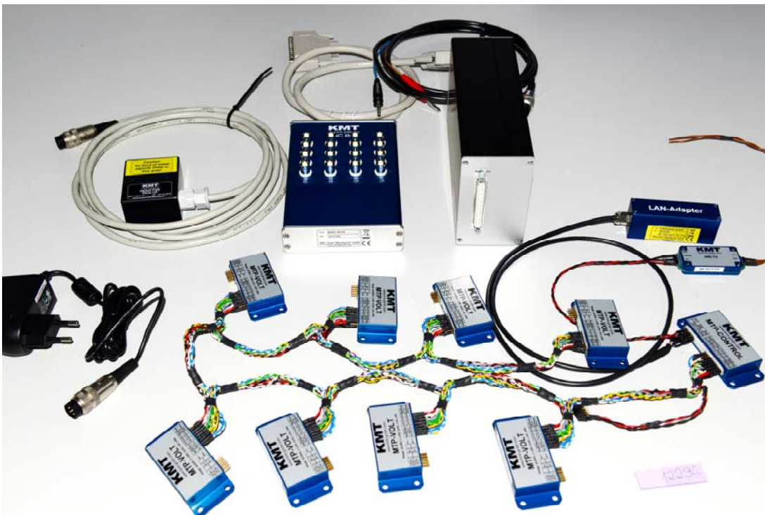
MTP16, verwendete 16-Kanal Telemetrie mit induktiver Datenübertragung, programmierbar
