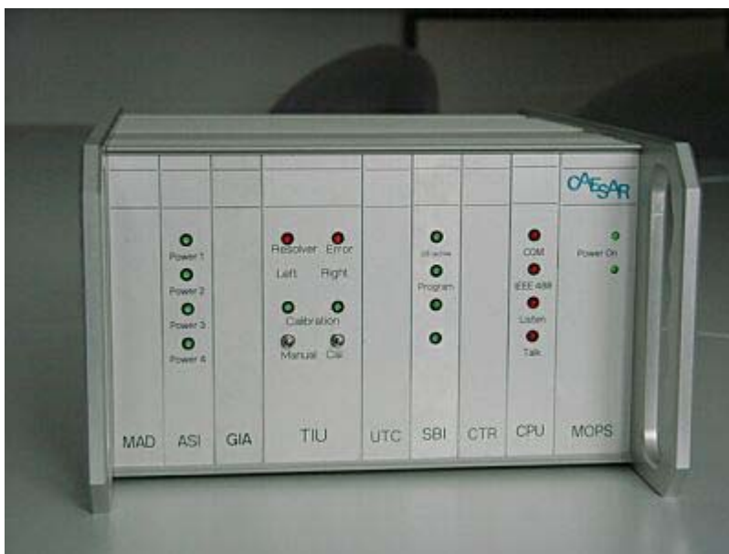
Bild 3: Das Vielkanal-Meßsystem MOPS ermöglicht die parallele Erfassung von Radlasten und beliebigen anderen Versuchsparametern
