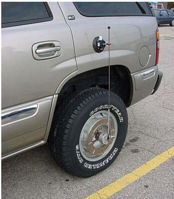
Bild 2: Die Telemetrie-Meßräder sind nicht nur äußerst kompakt, sondern ermöglichen auch eine schnelle und komfortable Montage und Ausrichtung
